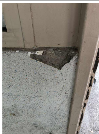
Prélèvement - P012 : RDC / LOCAL 02 - Enduit- (Absence d'amiante)
