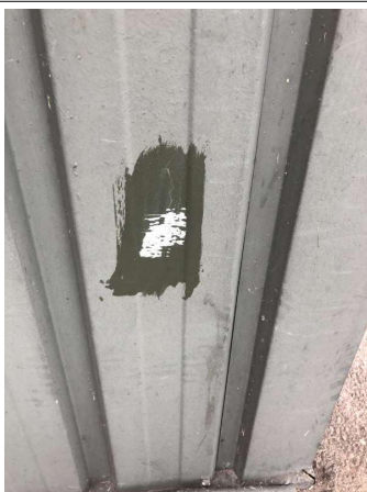
Prélèvement - P009 : FACADES - Peinture- (Absence d'amiante)
